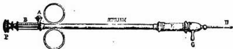
Fig. 123. — Seringue de Roubaud pour la fécondation artificielle. — E. Corps de pompe. — C. Canule d'aspiration. — D. Canule que l'on introduit dans l'utérus. — P. Piston. — B. Graduation indiquant le nombre de gouttes qui ont été poussées dans le corps de pompe. — A. Bouton qui en décrivant une demi-révolution ferme la canule d'aspiration C et ouvre la canule d'émission D.
